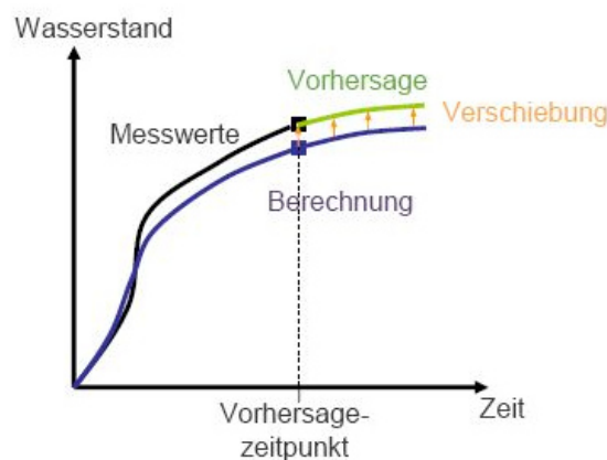
Bild 14: Konstante Verschiebung der Vorhersage anhand des letzten Messwertes (ARIMA-010-Korrektur) (Rademacher et al. 2009)
