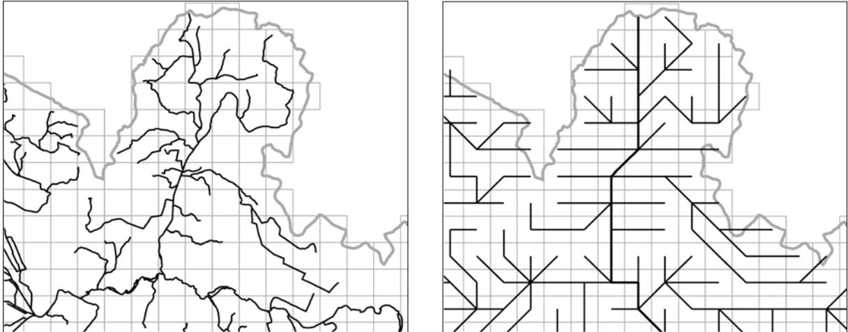
**Fig. 6.2 Exemple du réseau fluvial numérique (sur la gauche) et le système de propagation des crues dans les chenaux du modèle (sur la droite) (taille d'une cellule de maillage : 1x1 km)**
