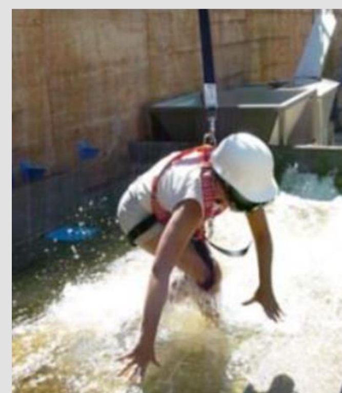
Experiment zur Ermittlung von Stabilitätskriterien für Fußgänger [2].
