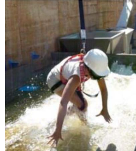
Experiment zur Ermittlung von Stabilitätskriterien für Fußgänger [2].
